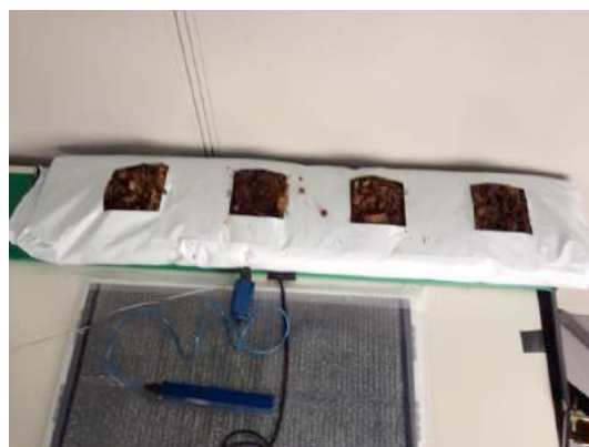
図 8. ヒーターによる培地加温の様子
